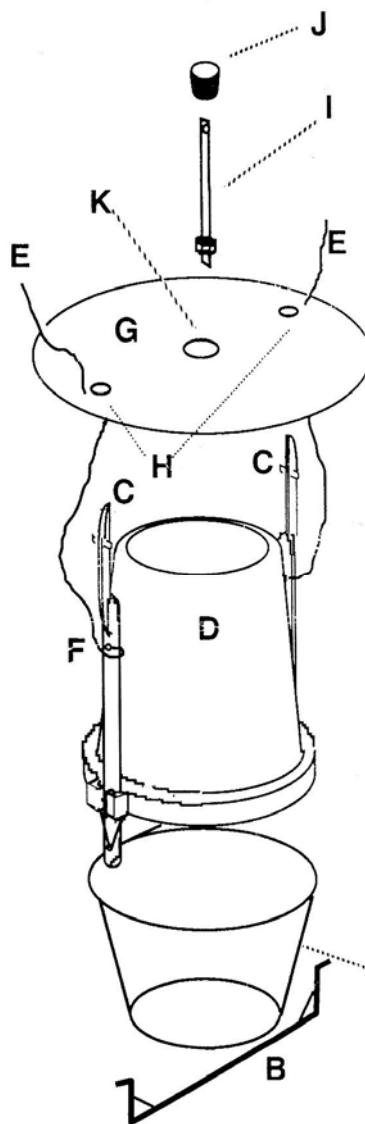
3. Postavite zeleni poklopac (E) na levak i učvrstite ih sa strane kroz rupe (F) koje su na bočnoj letvi.
